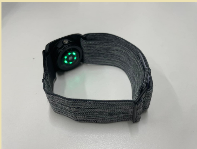
圖1及圖2: 佩戴於手臂的光學心率感應器，數據能上傳至智能裝置，用作分析比賽及訓練表現
